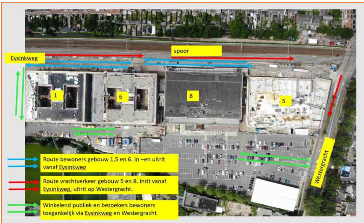
Afbeelding 3 Toekomstige verkeersstromen op het terrein van Plaza West [07], waarop te zien is dat het de bedoeling is dat er tussen gebouw 5 en het spoor geen winkelend publiek of bewoners komen. De routes voor het winkelpersoneel dat gebruik wil maken van de uitrit zijn niet in deze afbeelding opgenomen.
